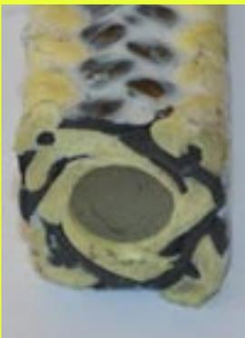
Sind z.B. geeignet gegen wässrige und basische Medien, insbesondere auch abrasive Medien wie kristallhaltige Lösungen, sandhaltige Solen, Salzbrei oder Zellstoffpulpen. Gegen Medien mit hoher mechanischer Verschleißwirkung ist die Packung aufgrund der Festigkeit der Ramiefaser gut geeignet. Durch die Fäulnisbeständigkeit der Ramiefaser besitzt die Packung eine hohe Lebensdauer.
