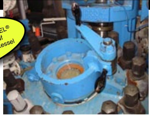
Offene DN 300 Einfüllöffnung
